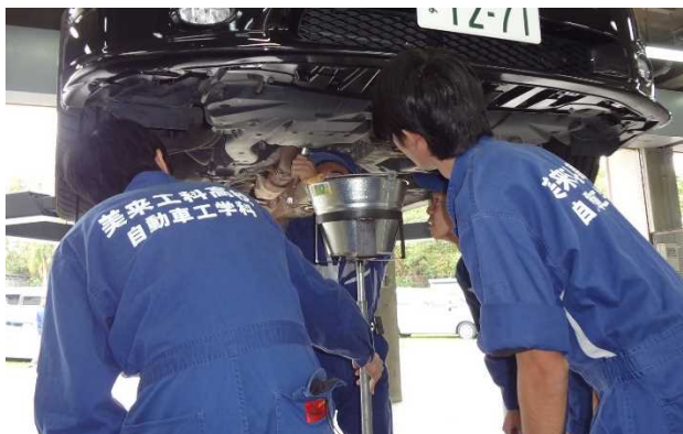
図 36 オイル交換+車両点検作業
